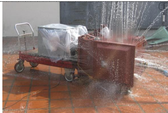
Thử nghiệm áp lực nước
