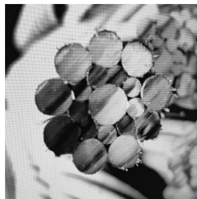
Hình 2. Kết cấu loại cáp neo 19 sợi
