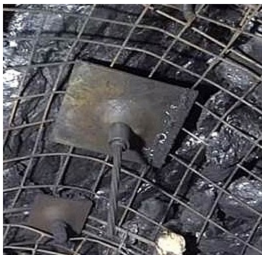
Hình 3. Các bộ phận cấu thành neo cáp sử dụng trong mỏ hầm lò
