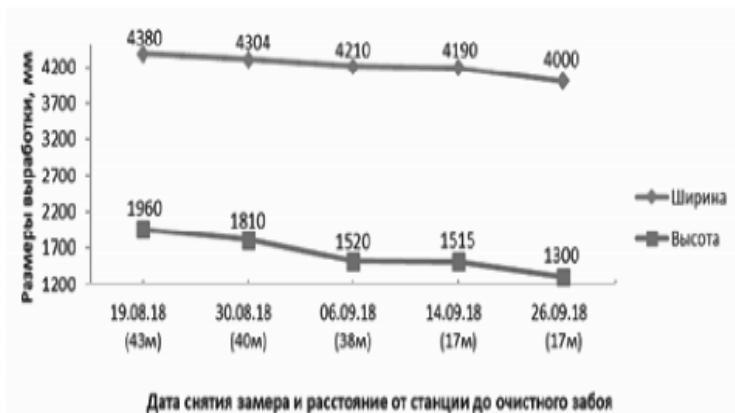
Hình 5. Kích thước lò dọc vỉa bằng tải lò chợ số 555 tại trạm đo đặc số 1 (ngoài vùng phá hủy bằng thủy lực có định hướng)
