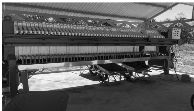
Hình 2. Một số hình ảnh thử nghiệm lọc bùn đỏ nhà máy alumin Tân Rai bằng thiết bị lọc ép khung bản
