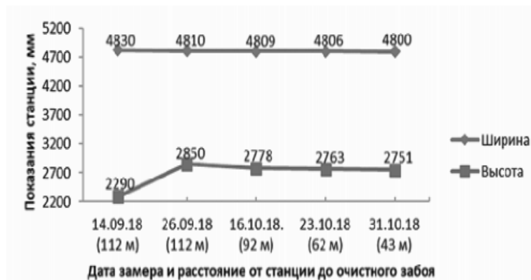
Hình 8. Kích thước lò dọc vỉa băng tải lò chợ số 555 tại trạm đo đặc số 3 (trong vùng phá hủy bằng thủy lực có định hướng)
