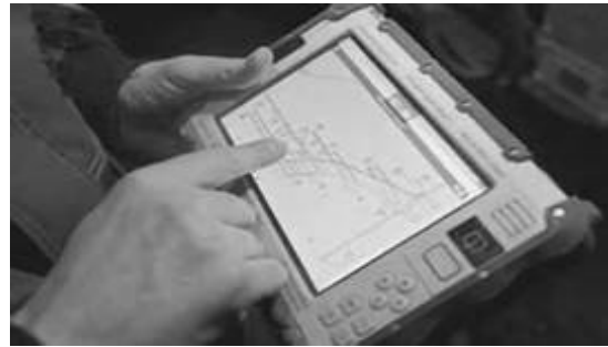
Trong điều kiện dưới hầm lò các thợ khai thác than của EVRAZ sử dụng máy tính bảng an toàn tia lửa
