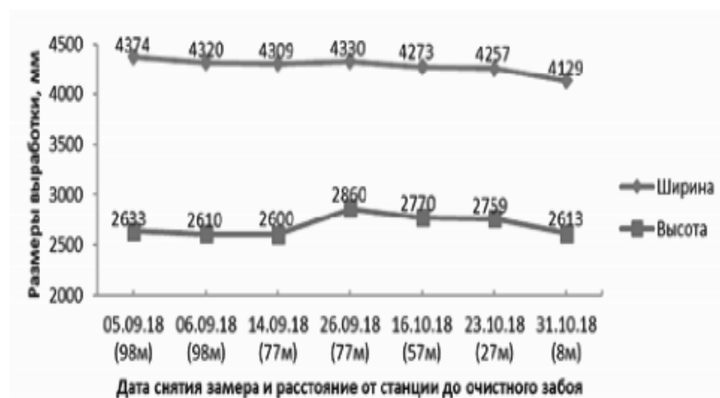
Hình 6. Kích thước lò dọc vỉa bằng tải lò chợ số 555 tại trạm đo đặc số 2 (trong vùng phá hủy bằng thủy lực có định hướng)
