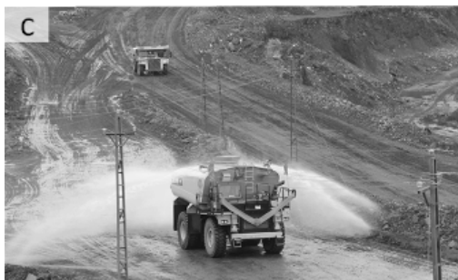
a) Thiết bị phun sương dập bụi cao áp lắp đặt tại Công ty than Tây Nam Đá Mài; b) Thiết bị phun sương dập bụi cao áp do Công ty VMIC chế tạo; c) Xe tưới đường chuyên dụng dung tích lớn của Công ty than Cao Sơn; d) Tường rào bảo vệ mặt bằng sản xuất của Công ty Tuyển than Cửa Ông Hình 2. Công tác chống bụi tại TKV
