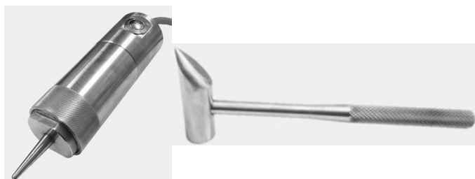
a) Máy chủ GD-RBT; b) Cảm biến gia tốc; c) Búa tay Hình 3. Hệ thống thiết bị kiểm tra chất lượng thanh neo (GD-RBT)
