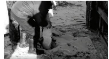
Hình 4. Minh họa cấu tạo và hình ảnh thực tế sử dụng thuốc nổ không chịu nước tại mỏ lộ thiên trên thế giới. 1. phễu nạp thuốc; 2. túi nilon
