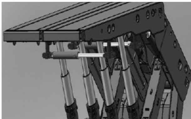
a. Vị trí lắp đặt kích chống đỡ
