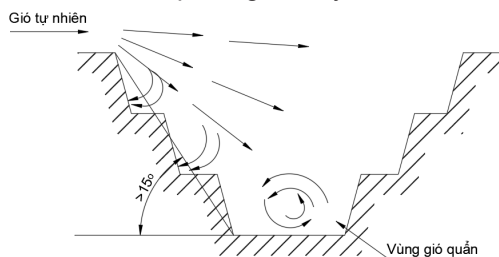
Hình 2. Vận động của khí quyển mỏ khi góc dốc bờ mỏ > 15°
