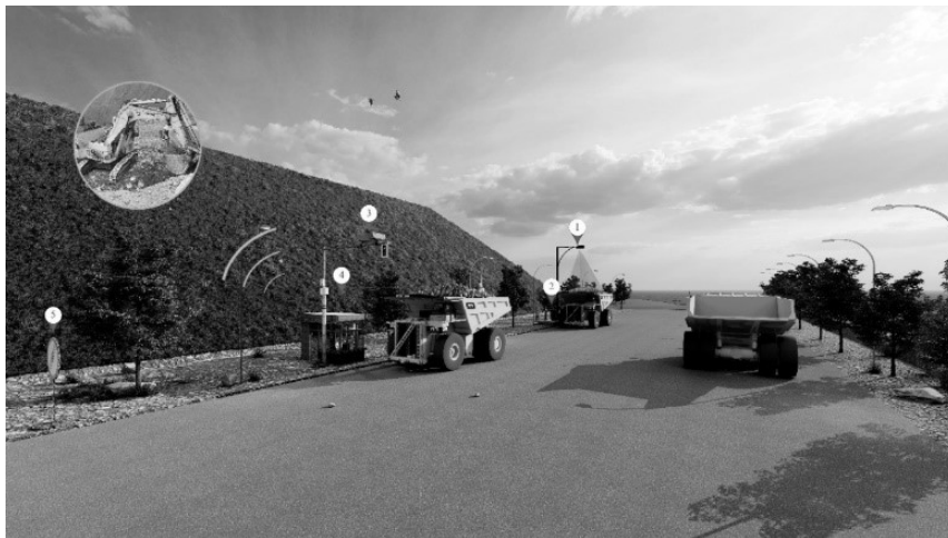
Hình 12. Hệ thống giám sát, cảnh báo mô hình chất tải trên các ô tô vận chuyển đất đá.
