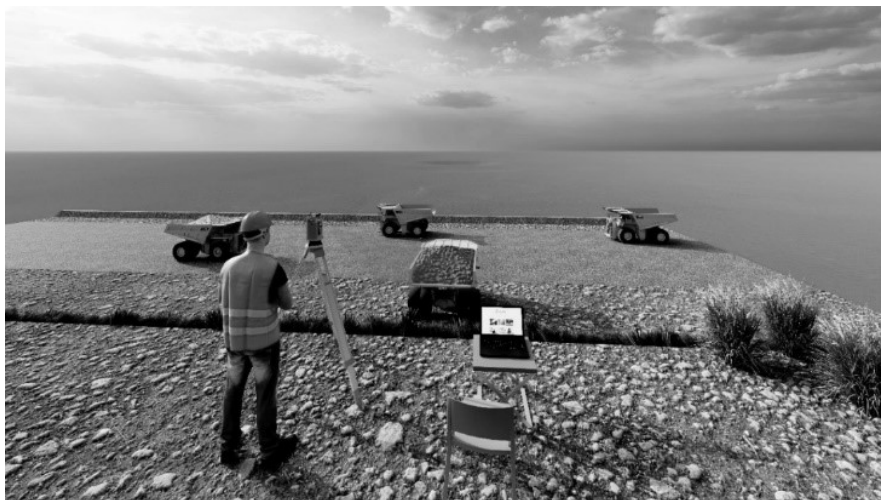
Hình 4. Mô phỏng 3D vị trí đặt hệ thống quét laser 3D tại thực địa
