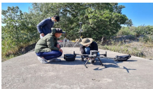
Hình 12. Thiết bị bay Lidar Matrice 300 RTK- Bãi thải Nam Lộ Phong
