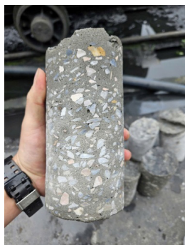
Hình 4. Khoan lấy mẫu bê tông phun trong lò tại hình 3, hình 4.
