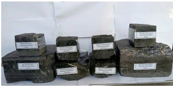
Hình 4. Mẫu Than loại 1, than loại 2, trung gian và đá mỏ than Hà Lâm
