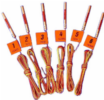
Hình 5. Kíp điện vi sai an toàn KVA.8Đ và máy nổ mìn KZS-1/02
