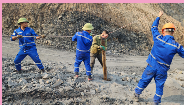
Công tác nạp ống CO 2 lỏng vào lỗ khoan
