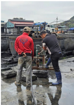
Hình 4. Khoan lấy mẫu bê tông phun trong lò tại hình 3, hình 4.
