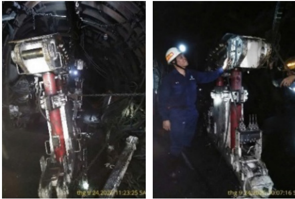
a) Lắp ghép các bộ phận thành đơn nguyên giàn chống hoàn chỉnh trong lò
