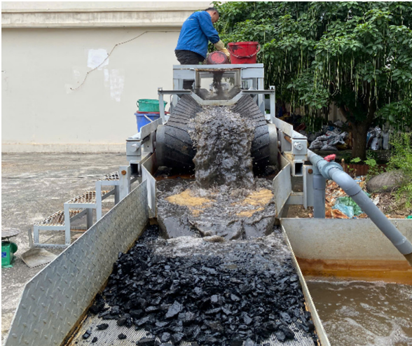
Hình 3. Thí nghiệm tuyển SPNT bằng thiết bị tuyển băng tải tại phòng thí nghiệm
