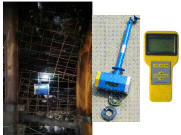
Hình 4. Thiết bị quan trắc đo dịch chuyển đá vách lắp đặt tại Nam Mẫu
