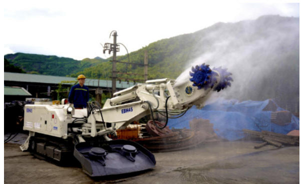
Hình 2. Máy combai đào lò EBH-45 đáp ứng tốt yêu cầu sản xuất.
