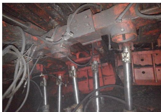
Hình 3. Kiểm tra làm việc thực tế của giá khung quá độ GKQĐ/2000/1.6/2.4 tại lò chợ I-6A-4 Công ty than Nam Mẫu
