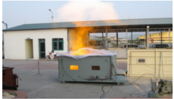
Hình 02. Thực hiện thử nghiệm xác định tính không lan truyền bắt cháy bên trong
