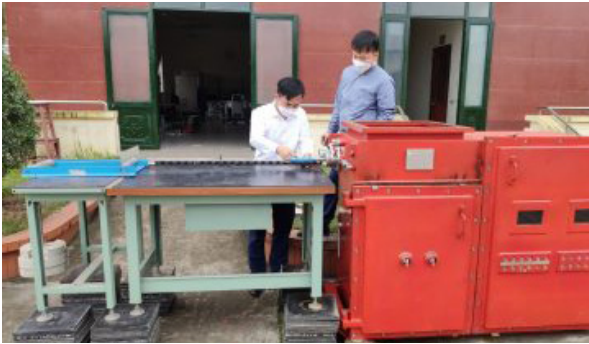
Hình 01. Thực hiện thử nghiệm xác định độ kẹp chặt của vòng kẹp cáp
