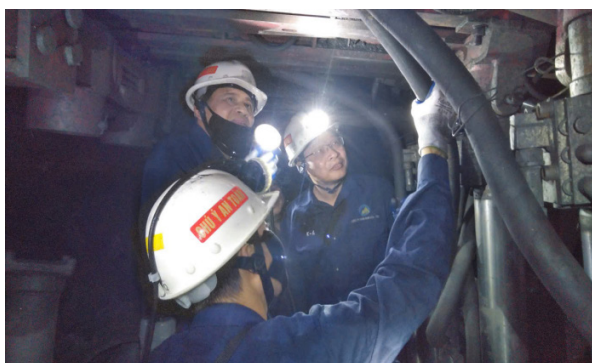
Hình 3. Kiểm tra làm việc thực tế của giá khung quá độ GKQĐ/2000/1.6/2.4 tại lò chợ I-6A-4 Công ty than Nam Mẫu
