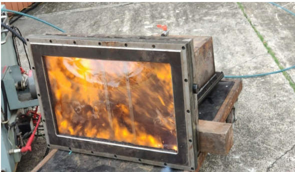
Hình 03. Thực hiện thử nghiệm xác định áp suất nổ chuẩn
