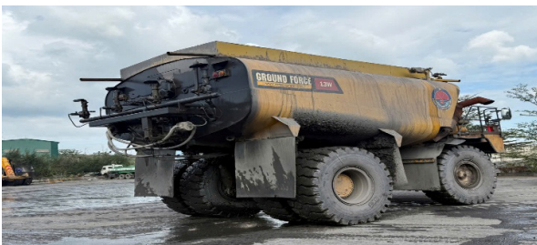
c) Xe tưới nước CAT 773E 50m3 Công ty than Cao Sơn
