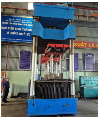
Hình 2. Công tác sản xuất chế tạo và kiểm định giá khung quá độ GKQĐ/2000/1.6/2.4
