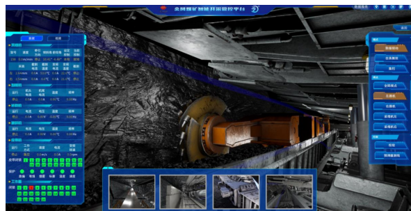
Hình 3. Giao diện phần mềm điều khiển lò chợ thông minh đang ứng dụng tại Trung Quốc
