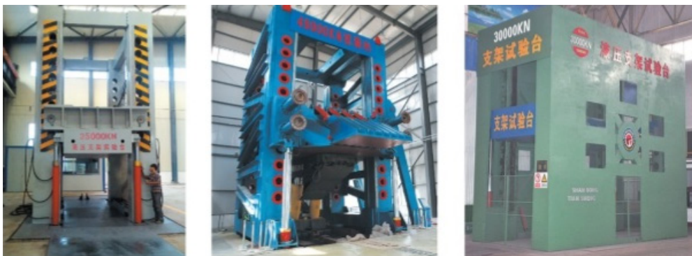
Hình 3. Một số thiết bị khung thử tải giàn chống thủy lực kiểu gia tải trong của Trung Quốc
