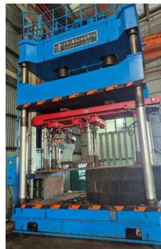
Hình 2. Khung thử tải của Trung tâm kiểm định công nghiệp 1
