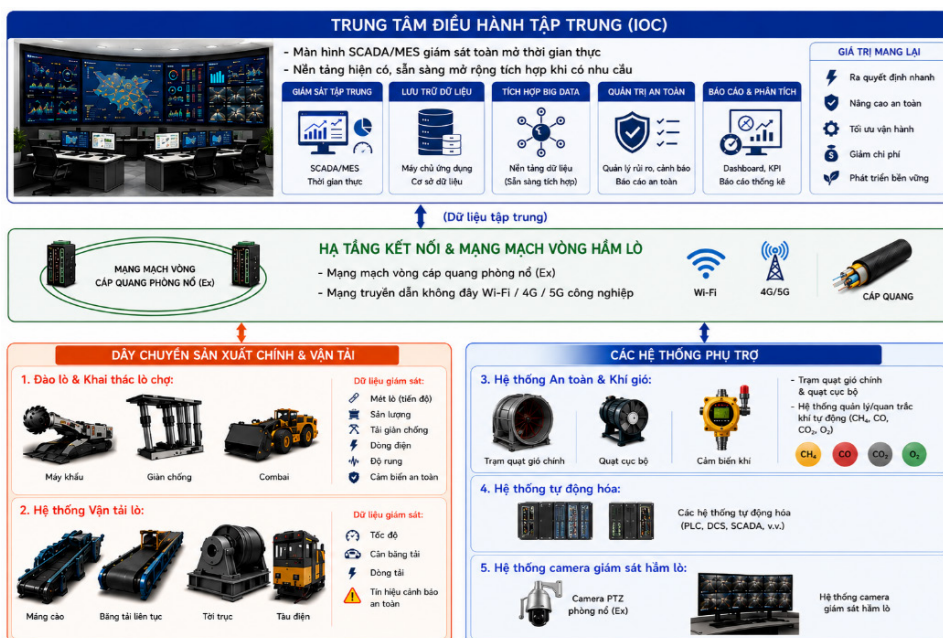
Hình 1. Sơ đồ mô hình hệ thống tự động hóa trong mỏ than hầm lò
