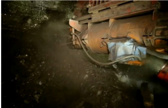
Hình 7. Hệ thống phun sương dập bụi tại đầu khẩu máy đào lò
