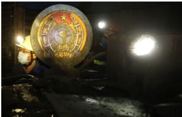
Hình 8. Hệ thống chiếu sáng lắp đặt trên thân máy đào lò
